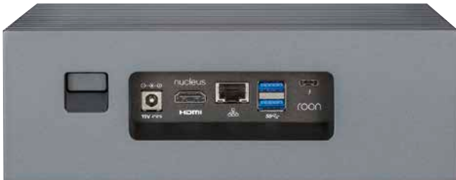
▲ Exotisch: Die HDMI-Schnittstelle gibt Stereo- und Multichannel-Audio aus.
