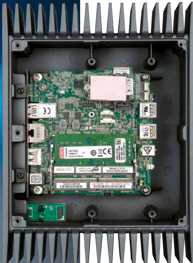
▲ Technisch ist der Nucleus unauffällig: Die Basis bildet ein NUC-Board von Intel mit i3-Prozessor. Zur Musikmaschine wird er erst durch sein angepasstes, entschlacktes Linux-Betriebssystem.
