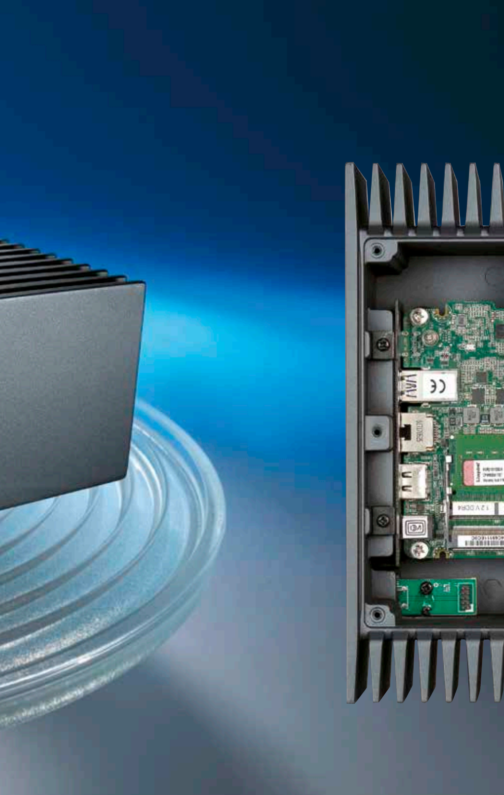
▲ Technisch ist der Nucleus unauffällig: Die Basis bildet ein NUC-Board von Intel mit i3-Prozessor. Zur Musikmaschine wird er erst durch sein angepasstes, entschlacktes Linux-Betriebssystem.
