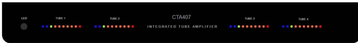
Jeder der vier Leistungsröhren sind 10 farbige LEDs zugeordnet, welche Auskunft über den Status der den LEDs zugeordneten Röhre geben. **TUBE 1** (V1) und **TUBE 2** (V2) beziehen sich auf den linken Kanal, **TUBE 3** (V3) und **TUBE 4** (V4) stehen für den rechten Kanal. Nach der Inbetriebnahme kann es bis zu 60 Sekunden dauern, bis die Arbeitspunkte aller Bauteile stabilisiert sind. Die Diagnose wird danach automatisch gestartet.
