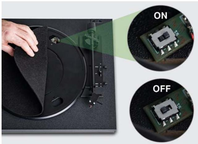
Schalterstellung bei Anschluss an einen Verstärker **ohne** integrierten Phono-Vorverstärker.
