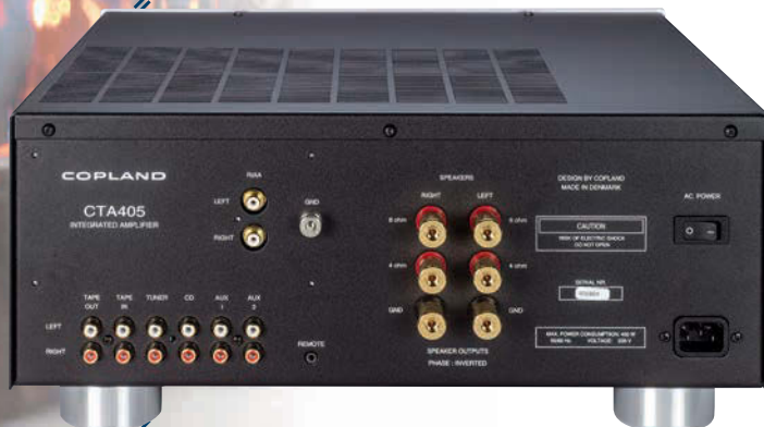
Das Anschlussfeld mit WBT-Buchsen verfügt über Abgriffe für 4- und 8-Ohm Boxen
