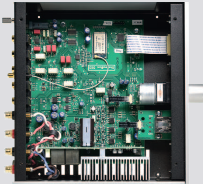
Alles klein: die Fernbedienung, die Klemmen, die Kühlrippen, stattdlich aber das zentrale Potentiometer.
