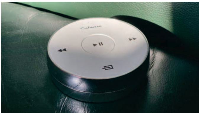
Die schicke Fernbedienung nutzt Bluetooth statt Infrarot und braucht dadurch keine direkte Sicht auf den Subwoofer.
