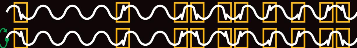
Wenn das Signal den Empfänger erreicht, wird eine Leitung invertiert. Jetzt sind beide Signalstränge identisch. Die Rauschspitzen aber weisen in die entgegengesetzte Richtung.
