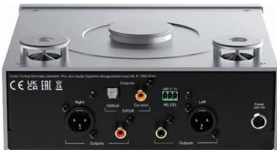
Die Rückseite der Pro-Ject CD Box RS2 Tube bietet symmetrische XLR- und Cinch-Ausgänge sowie optische und koaxiale Digitalausgänge plus Anschluss fürs Netzteil
