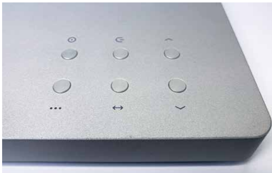
An/Aus, Quelle, Laut/Leise, Mehr bzw Optionen und Zurück. Das Bedienkonzept ist klar und einfach strukturiert
