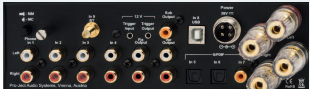
Hier bleiben, trotz kompaktester Abmessungen, keine Wünsche offen: Phono-MM und -MC, drei analoge Eingänge, vier digitale Eingänge inkl. USB-B, dazu Sub-Out und Bluetooth. Geil.
