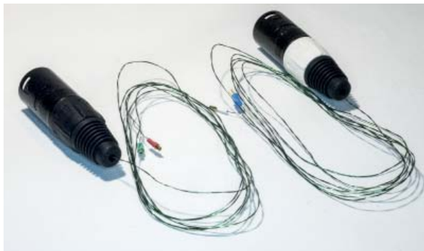
Beispiel für eine improvisierte Verkabelung mit verdrehen Litzen
