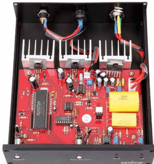
**Das externe Netz- und Steuerteil besteht mit hochwertigen Bauteilen. Auf kleine Kühlkörper montierte Transistoren garantieren Stabilität.**
