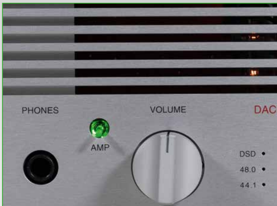
Das Design des DAC215 erinnert an die 1970er Jahre und somit an die goldene Ära der Audiophilie- Der grün leuchtende Kippschalter wird bei ausgeschalteter Vorstufe rot illuminiert
