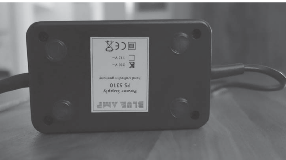
Das Netzteil ist ausgelagert. Die neueren Versionen erkennt man an dem farblich gekennzeichneten Quadrat.
