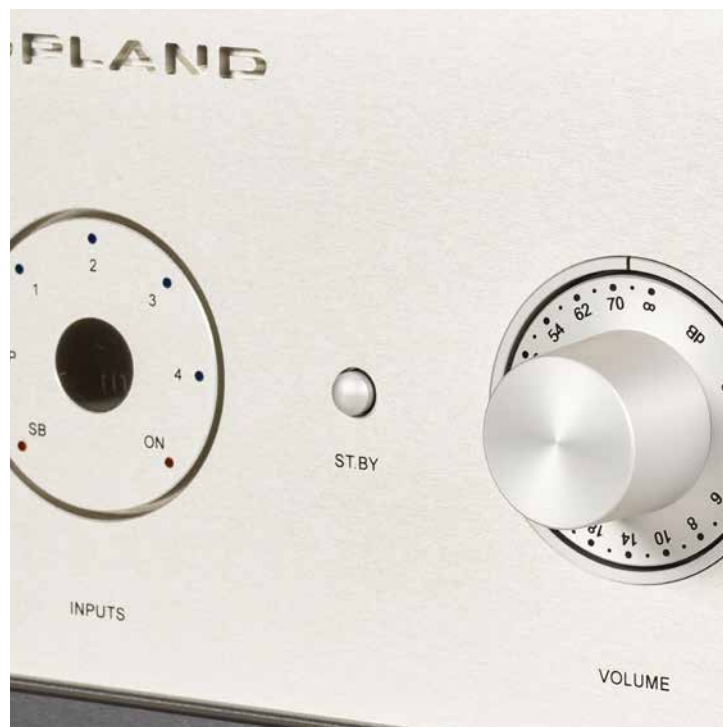
Detailansichten von Fernbedienung und Pegelsteller nebst abschaltbarer LED-Eingangsanzeige und Standby-Schalter. Der Copland ist bis in seinen hintersten Winkel superb verarbeitet.
