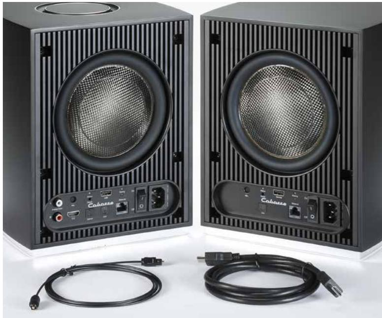
Der Hauptlautsprecher (links) verfügt über mehr Anschlüsse und den Controller „oben auf dem Kopf“, am Netz hängen aber beide.
