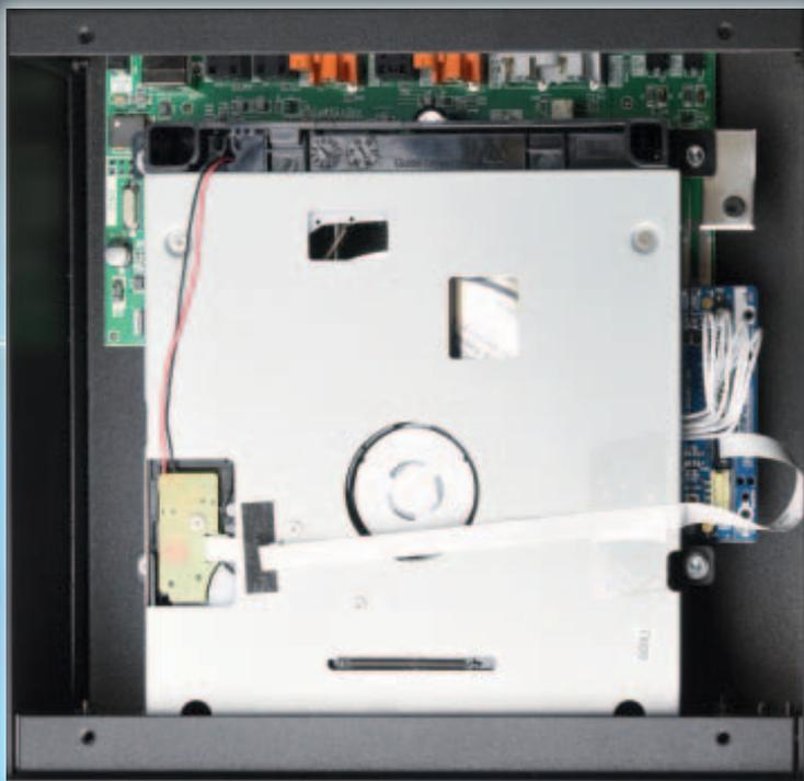
Das Laufwerk verdeckt einen Großteil der Elektronik. Aber eigentlich ist das Laufwerk ja auch der Star dieses kleinen Kästchens. Ein StreamUnlimited „Blue Tiger“ CD-80 CD-Laufwerk mit Servo-Regelung und Slot-Loader-Mechanik.
