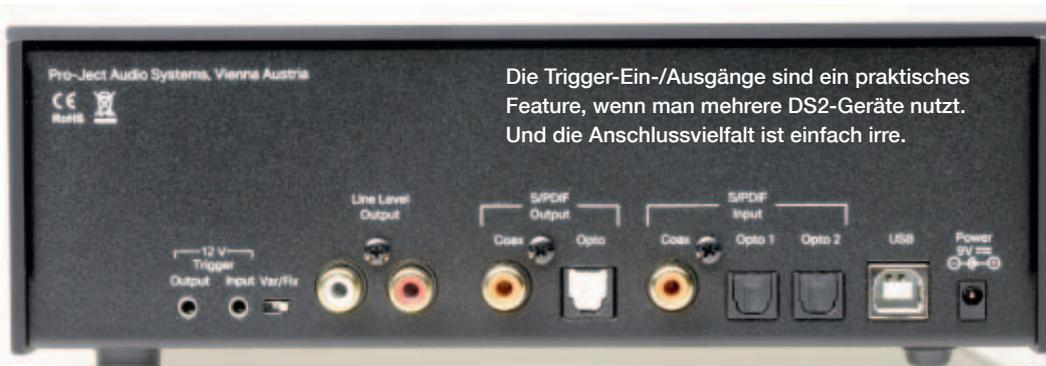
Die Trigger-Ein-/Ausgänge sind ein praktisches Feature, wenn man mehrere DS2-Geräte nutzt. Und die Anschlussvielfalt ist einfach irre.
