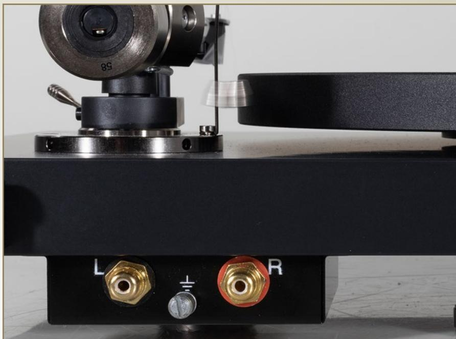
Die Anschlüsse sind simpel aber gut ausgeführt. Besonders hat uns gefreut, dass diese nicht sonderlich versteckt, sondern gut zugänglich ausgeführt sind
