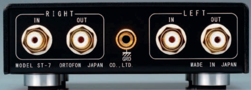
Hier kann man nichts falsch machen. Eingänge, Ausgänge und eine Erdungsschraube. Übertrager benötigen keine Stromversorgung.
