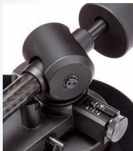
▲ Die Anti-Skating funktioniert nicht wie sonst per Faden und Gewicht, sondern magnetisch.
