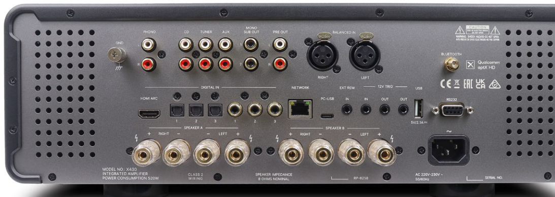
An Anschlüssen lässt der X430 kaum Wünsche übrig: Digital inklusive HDMI und USB-C, Analog inklusive Phono MM und XLR, Subwoofer-Verbindungen, zwei Paar Boxenausgänge.
